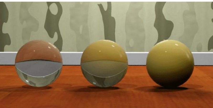
На всех объектах прозрачность переключена в режим solid , т.е. рассматривается как монолитный объект с толщиной. Слева: Weight = 0,0; в центре: 0,5; справа: 1,0
