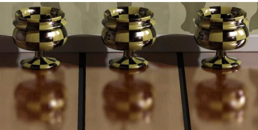
Доскам пола даны материалы с разными настройками. Слева: опция High detail distance отключена. В центре: High detail distance = 25 мм. Справа: High detail distance = 150 мм
