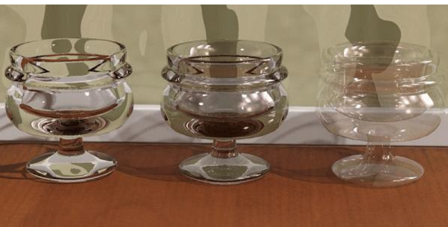
Слева: чаша использует преломление на основе IOR . В центре: чаша использует преломление на основе BRDF ( 90 \text{ deg. refl.} = 1,0 и 0 \text{ deg. refl.} = 0,2 ); выглядит как металлизированное, тонированное стекло. Справа: чаша тоже использует преломление на основе BRDF , но прозрачность переключена в режим thin-walled , т.е. рассматривается как тонкостенный объект. Этот метод лучше подходит для создания непреломляющих прозрачных объектов, например тюли, чем использовать IOR = 1,0, как показано на предыдущей иллюстрации
