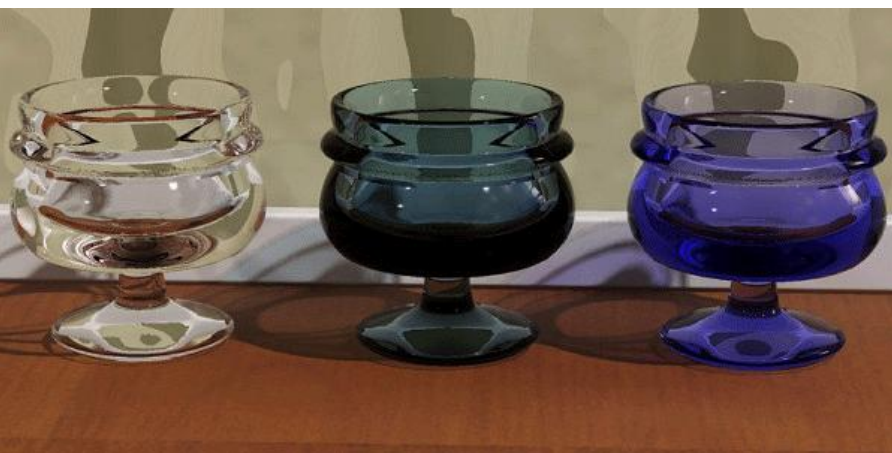
Слева: опция Max Distance отключена. В центре: опция Max Distance включена, затухание идет в черный цвет. Справа: опция Max Distance включена, затухание идет в синий цвет (параметр Color at Max Distance )
